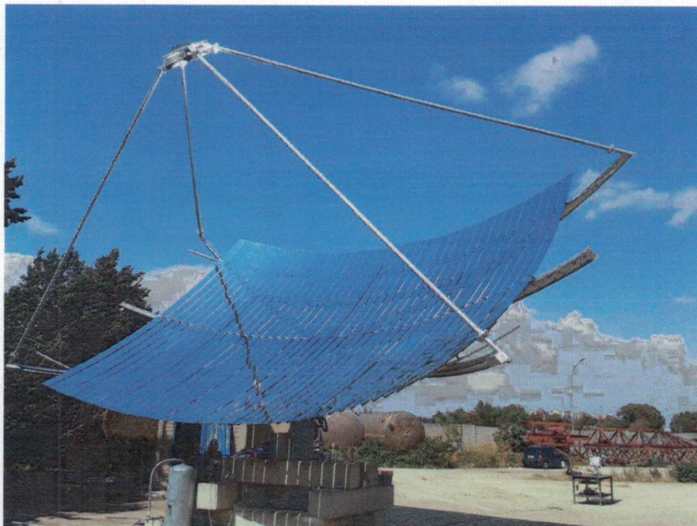
(a) Vista complessiva del collettore durante le attività di prova
